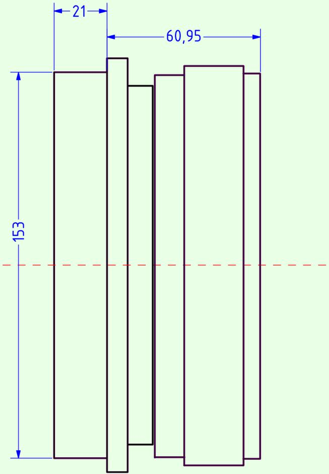
Der Lochkreis für den VOLT-Mitteltöner in der äußeren Schallwand (153mm Durchmesser) ist vorne 1mm mit 45° angefast. Der Ausschnitt in der inneren Schallwand hat die Maße 165mm x 165mm (inkl. 1mm Toleranz). Der Mitteltöner wird durch die Schallwandöffnung für den Tieftöner ins Gehäuse geführt und von innen montiert.
